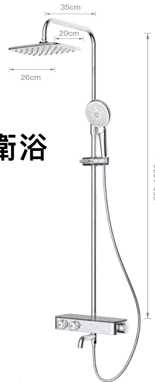
⑤ S788C (冷熱進水口中心離地 800mm 以上，間距 150mm)
